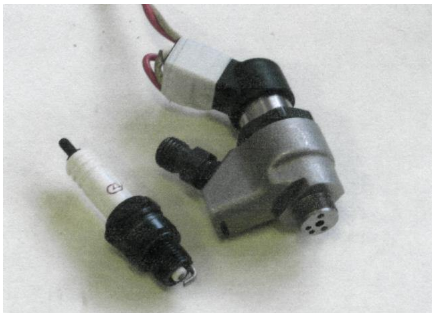
Пьезоактюатор линейного принципа действия форсунки фирмы Siemens
