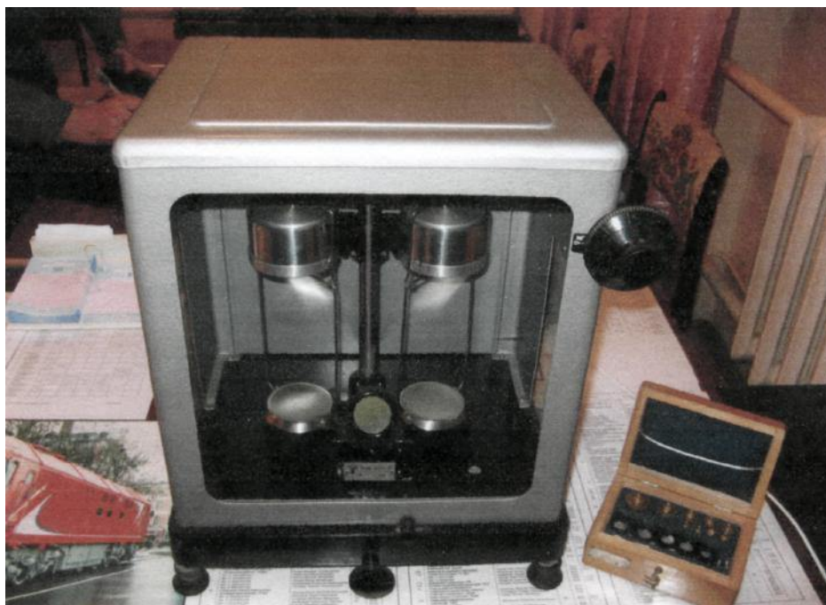
Стенд для исследования гигроскопичности пористых пьезокерамических материалов
